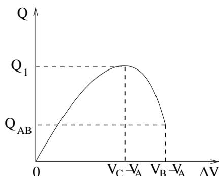
Figura 4: O calor recebido pelo gás no processo linear AB
